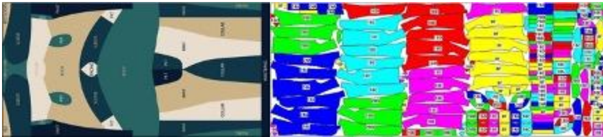
Görsel 13: Holly McQuillan’ın Twinset sıfır atık kalıpları ve geleneksel pastal yerleşimi karşılaştırılması
