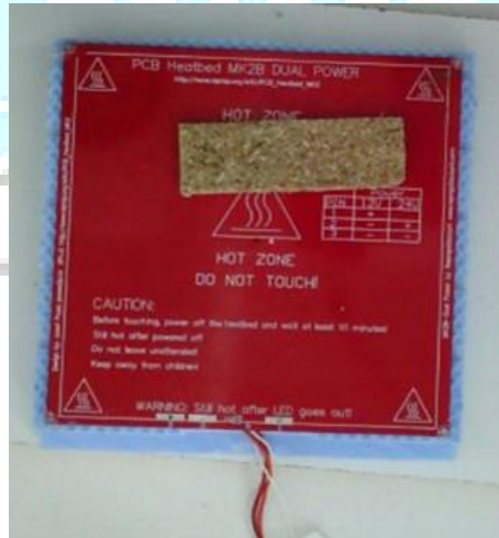
Görsel 5. Elektrikli rezistans ile ısıtma
