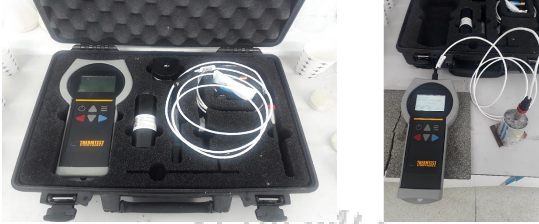
Görsel 4. Isı iletim katsayısı ölçüm testleri
