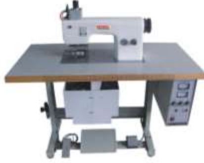
Görsel 8. Ultrasonik Dikiş Makinesi [17]
