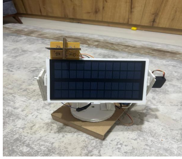
Göster 1. Kontrol algoritmasının uygulandığı çift eksenli prototipin genel görünümü.
