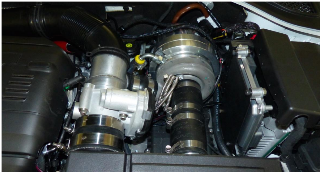
Şekil 8. Eq Boost sistemi turboşarjın elektrikli kompresörle beslenmesi[8]
