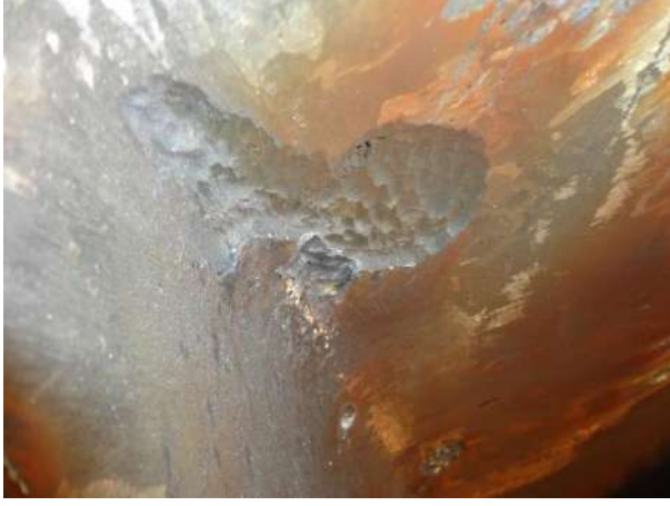
Şekil 3. Kaviteasyon olayına maruz kalmış türbin çarkının temizlenmiş durumu
