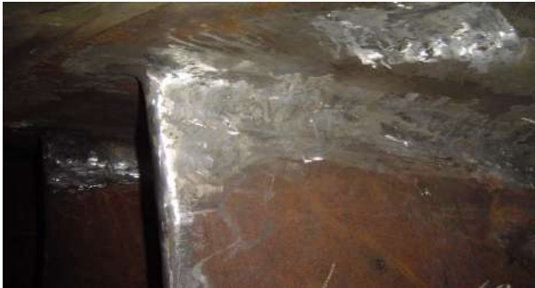
Şekil 5. Türbin çarkı yüzeyinin tamirattan sonraki son hali
