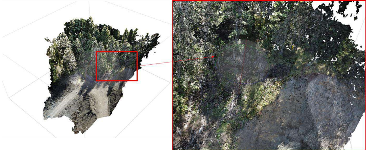
Şekil 9. Eğik kamera açısıyla orman altı topografyanın modellenmesi (yoğun nokta bulutu görüntüsü)
