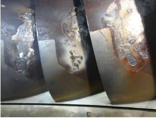
Şekil 4. Türbin çarkının temizlenmiş yüzeylerinin dolgu kaynağı ile doldurulmuş durumu
