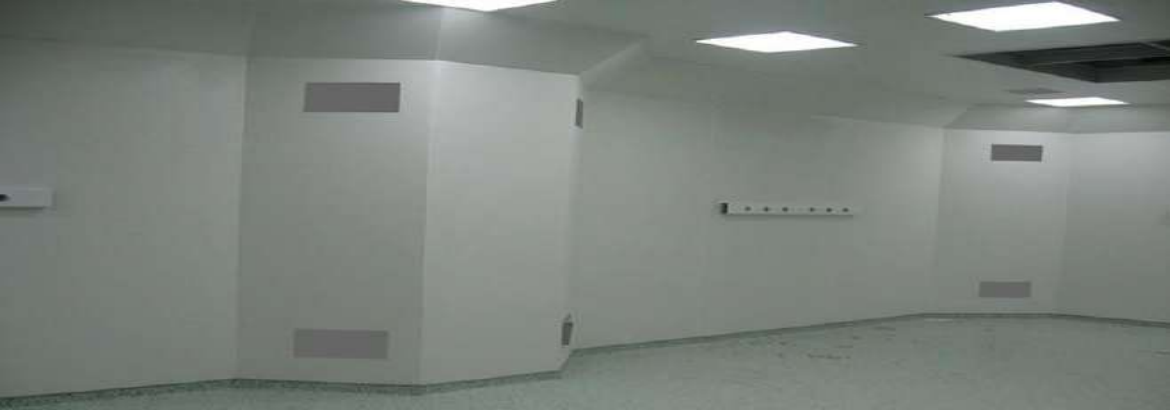
Şekil 3. Temiz Oda Duvar-Duvar, Duvar-Zemin (Birleşirme Noktalarında Köşeler Yuvarlatılmalıdır).
