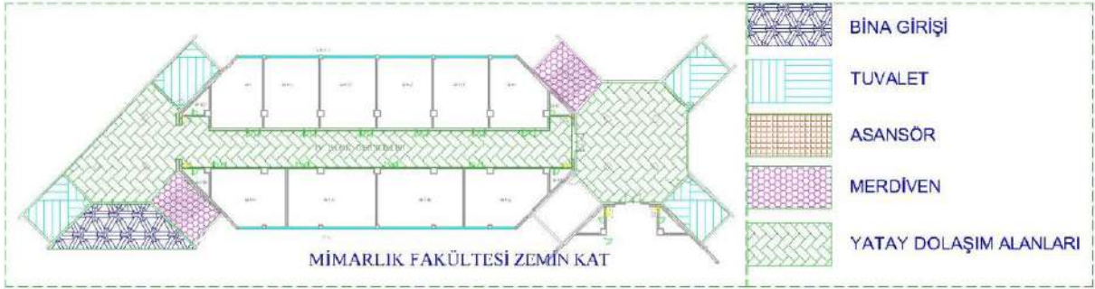
Şekil 10. Mimarlık Fakültesi Zemin Kat Lejant(Tunç 2017)
