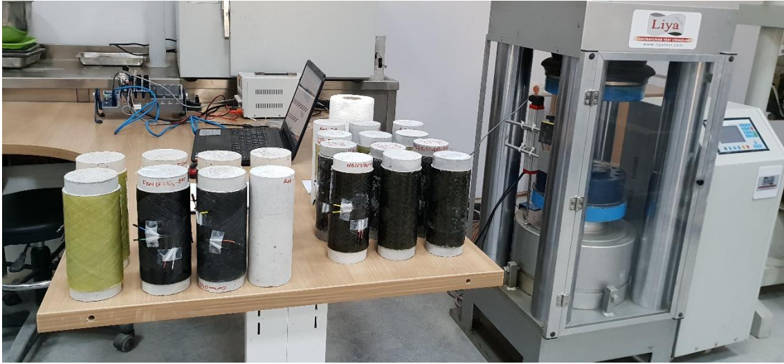
Şekil 3. Üretilen kompozit kolonların aksenal basma testleri için hazırlanan test cihazı
