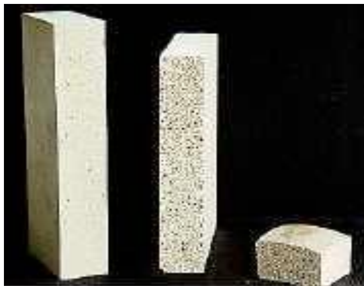
شکل 1-10: تولید بتن های گازی از ژئوپولیمیر
