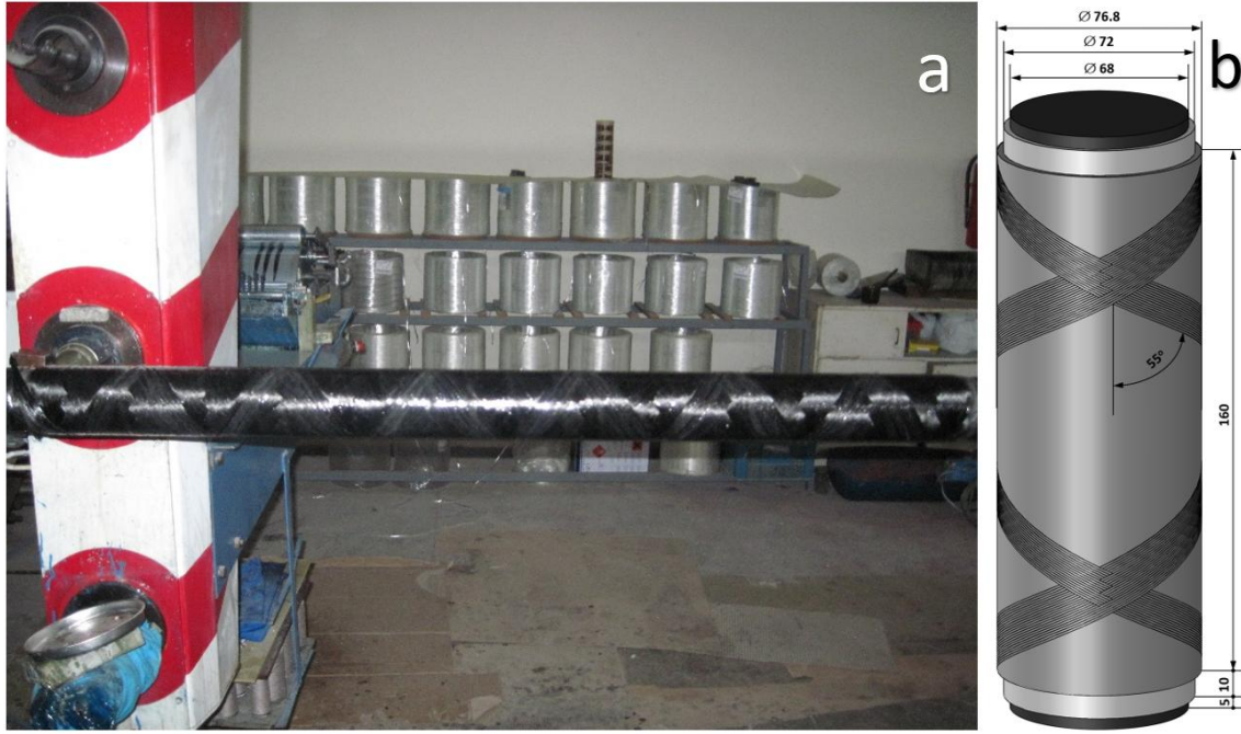
Şekil 1. a) Kompozit boruların filaman sarım tezgâhında üretimi b) kompozit kolon numunelerinin geometrik ölçüleri [17]
