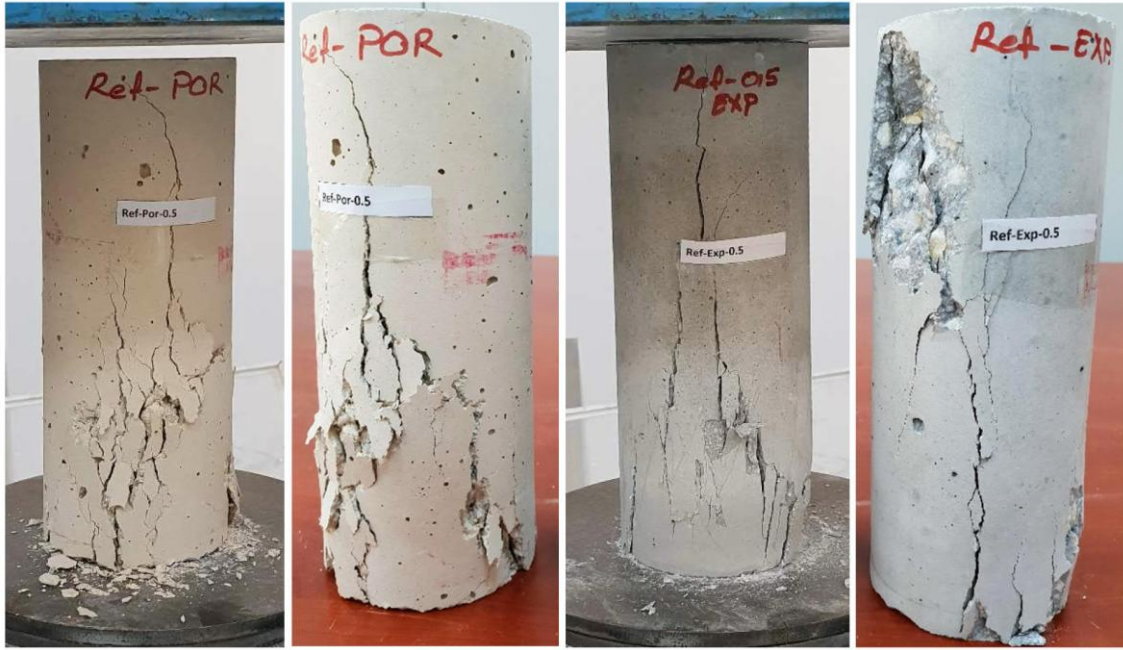
Şekil 3. Referans numunelerinin basma testi sonrası hasar görünüşleri
