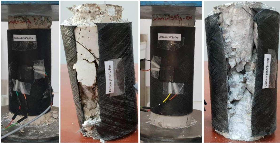
Şekil 4. Silindirik kompozit kolonların test esnasında ve sonrasında oluşan hasar görünüşleri
