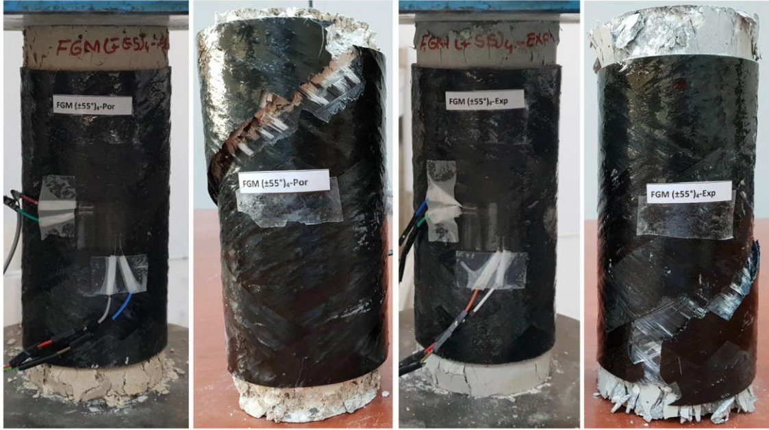
Şekil 3. Silindirik kompozit kolonların test esnasında ve sonrasında oluşan hasar görünüşleri
