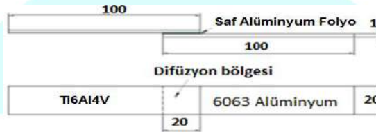
Şekil 1. Difüzyon kaynağı için hazırlanmış çekme deney numunesi
