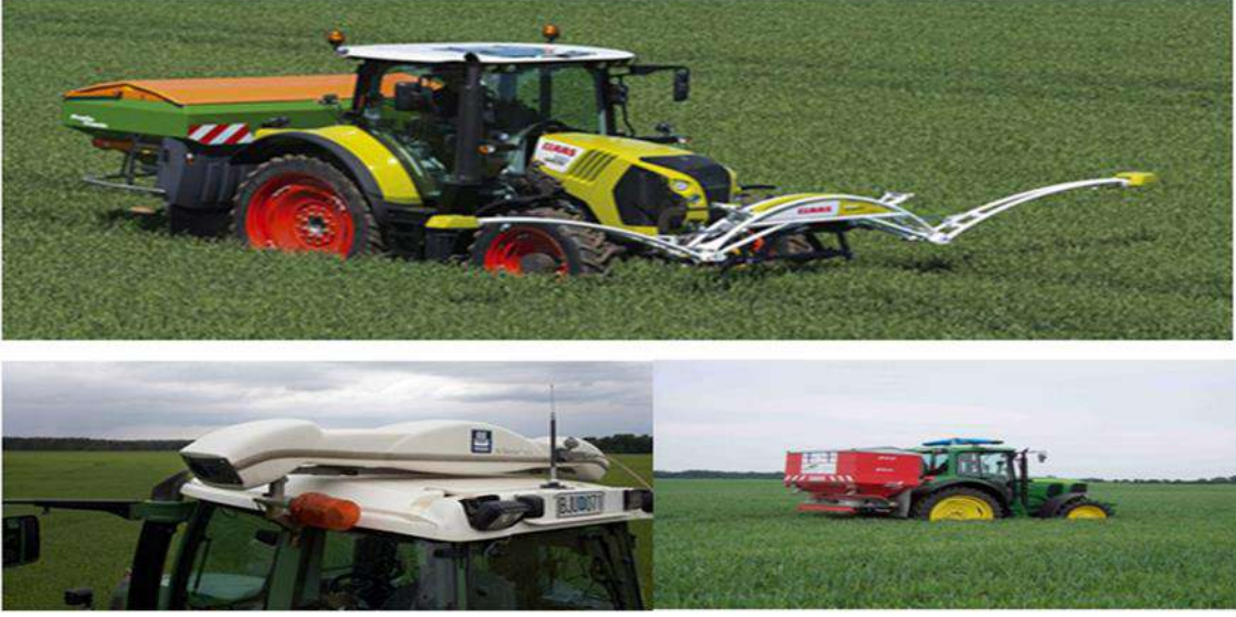
Şekil 4. Gübrelemede Sensör Tabanlı Ürün Algılama ve Değişken Oranlı Uygulamalar
