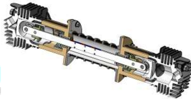
Görsel 3. 2-zamanlı mesafe uzatıcı kesit görünümü
