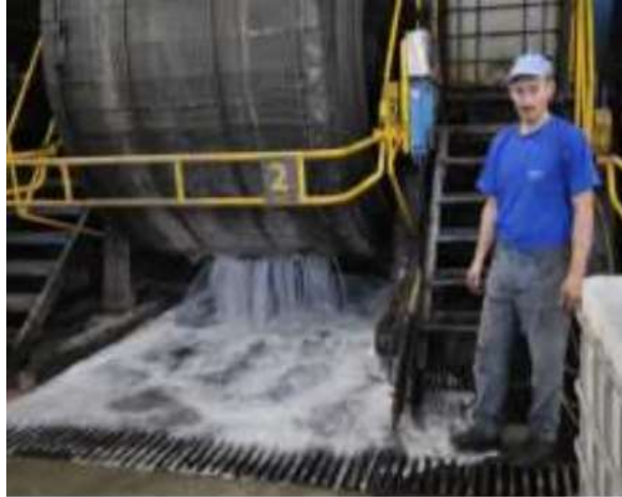
Görsel 2. Retenaj tamburunun boşaltılmasıyla kimyasallara maruz kalma [20].
