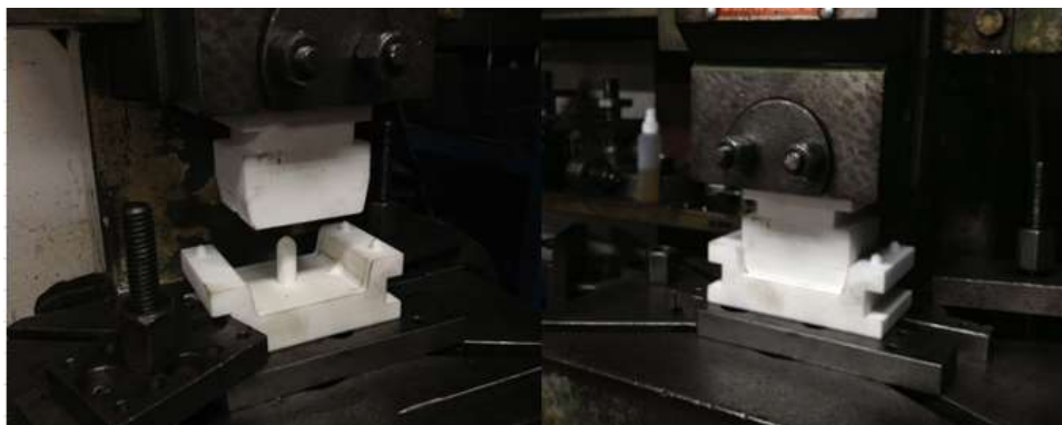
Görsel 6. Prototip kalıp plakalarının prese bağlanması ve strok ayarının yapılması.
