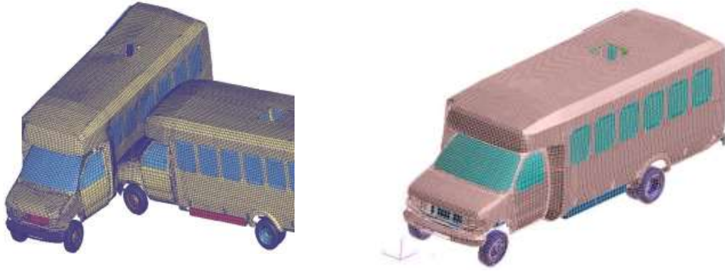
Görsel 15. Otobüse dönüştürülmüş araç modeli ve yandan çarpma senaryosu [21]
