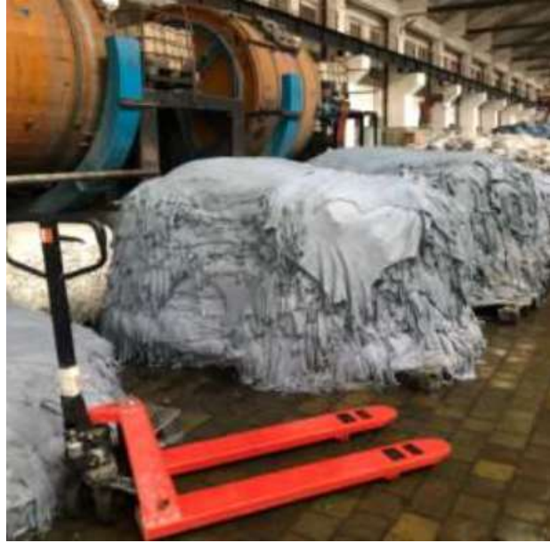
Görsel 10. El transpaletlerinin kullanılması nakliyei kolaylaştırır ve işçilerin ağır yük taşımalarını önler
