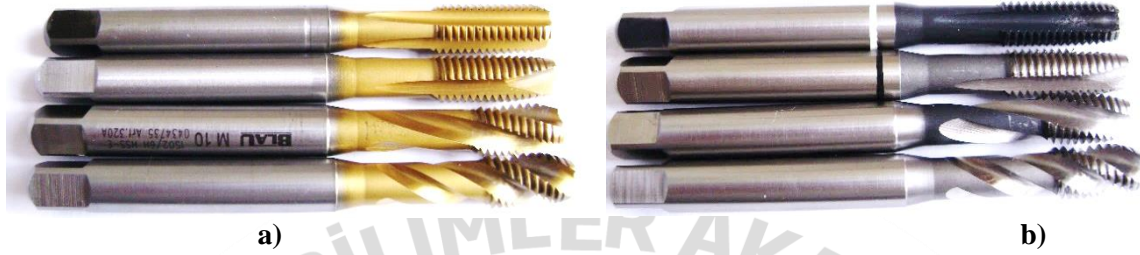
Görsel 1. Deneylerde kullanılan kılavuzlar (Blau, 2005): a) TiN kaplamalı, b) HSS
